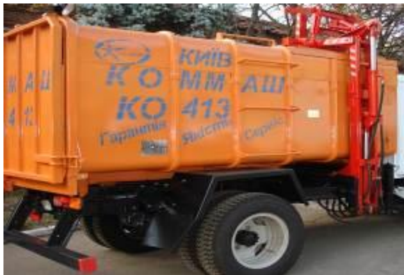
Ліворуч: КО-413 з боковим завантаженням, об'ємом 7,5 \text{ м}^3 ; можна завантажувати контейнери об'ємом 0,75 \text{ м}^3 та 1,1 \text{ м}^3
