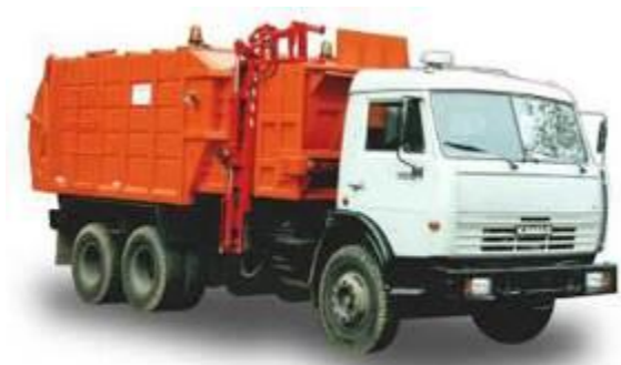
Ліворуч: МКМ-45 з боковим завантаженням, об'ємом 20 \text{ м}^3
