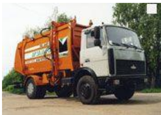
Праворуч: КО-426 з боковим завантаженням, об'ємом 18 \text{ м}^3
