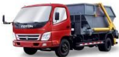
Рисунок 1. Вантажівка із гачковим автоматом підйому для контейнерів об’ємом 8 м 3 для збирання великогабаритних відходів
