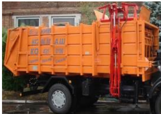
Праворуч: КО-435 з боковим завантаженням, об'ємом 18 \text{ м}^3 ; можна завантажувати контейнери об'ємом 0,75 \text{ м}^3 та 1 \text{ м}^3
