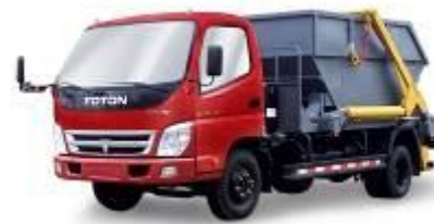
Гаково-підйомний автомобіль для великогабаритних відходів для контейнерів об'ємом 8 м 3 , які використовують в інших містах України
